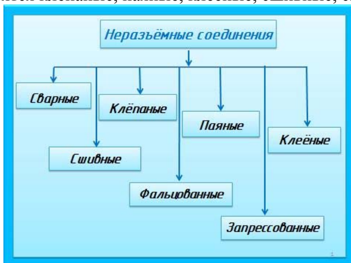
Рис. 114. Основные виды неразъемных соединений
