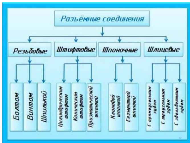
Рис. 113. Основные виды разъемных соединений
